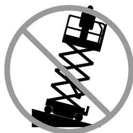
機械がしっかりと平坦な地面に設置されている場合以外は、作業台を上昇させないでください。
