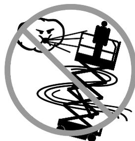
強風や突風の状況で機械を操作しないでください。作業台や積荷の表面積を大きくしないでください。風にあたる面積が増えるにつれて機械の安定性が低下します。
