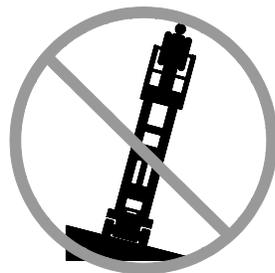
水平位置の指標として傾斜アラームに依存しないでください。傾斜アラームは、機械が急な斜面上にある場合にのみシャーシ上で鳴ります。
