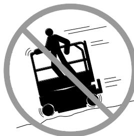
路面の状態、交通量、傾斜、人の位置、およびその他追突の要因となるものに従って、走行速度を制限してください。
